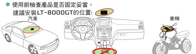
LT-8000GT 已內建 GPS 天線，但是在某些地區車內或有遮蔽物下，可能造成不易收到衛星訊號的發送，仍必須使用外接式接收衛星天線來改善接收衛星訊號。
